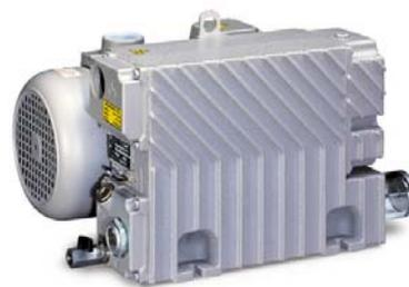
Все насосы серии L оборудованы автоматическим газобалластным устройством. Данный элемент в определенный момент цикла сжатия повышает давление в рабочей камере за счет смешивания атмосферного воздуха и откачиваемой среды, что позволяет избежать конденсации паров воды в рабочей камере.
